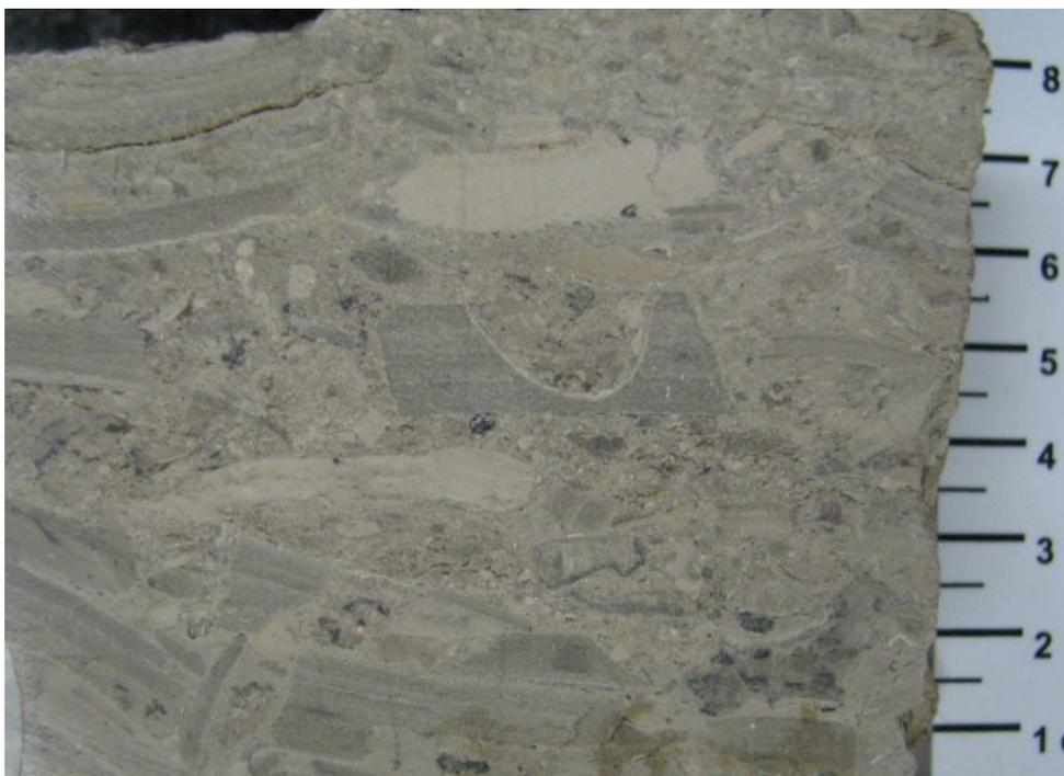
**Figura 58** – *Aspecto geral macroscópico da fácies Bi. Notar a variedade de tamanho e a angularidade dos fragmentos de estromatólitos, o que mostra pouco transporte após a fragmentação do material.*
