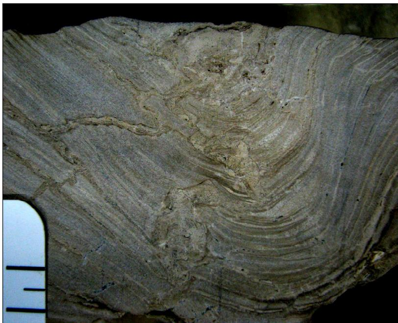
**Figura 47** – Amostra macroscópica da fácies Ed. Observar a laminação convoluta e gretas preenchidas por micrita argilosa (argilominerais), ora concordante e ora discordante com a laminação. (Escala em centímetros).
