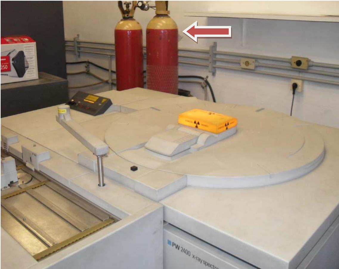
**FIGURA 1.17 - ESPECTRÔMETRO POR FLUORESCÊNCIA DE RAIOS-X (CILINDROS COM GÁS SEM SINALIZAÇÃO E FIXAÇÃO)**
