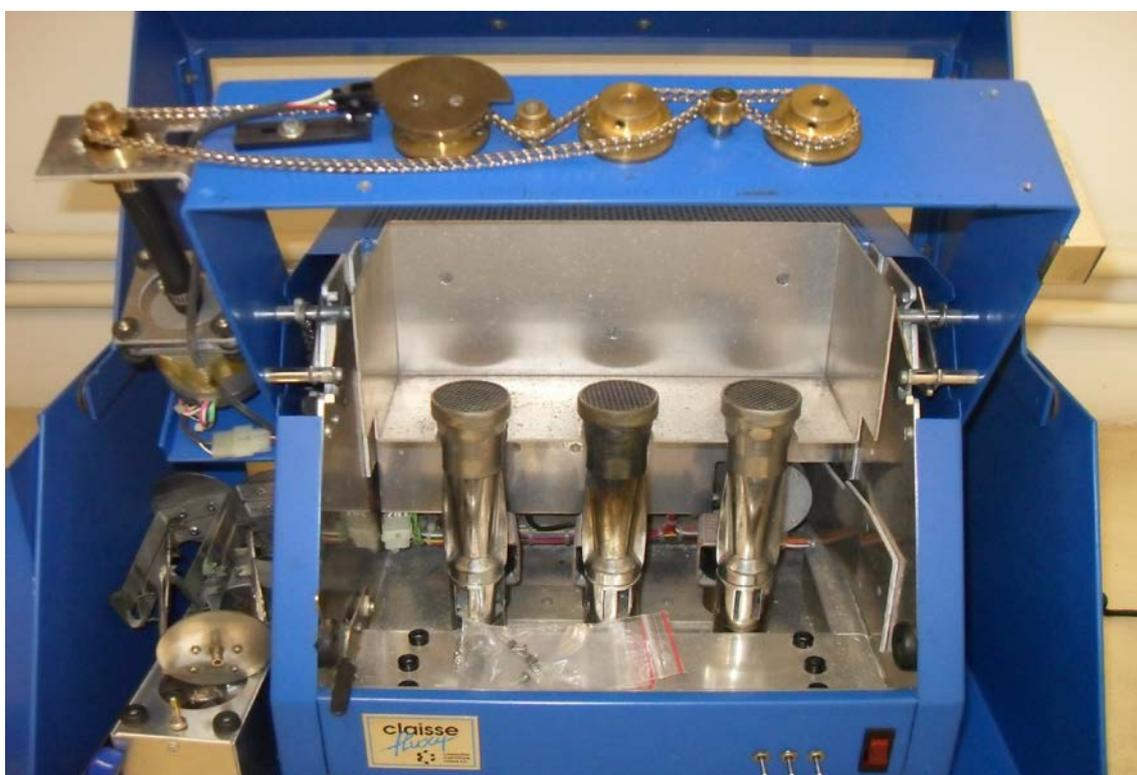
**FIGURA 1.11 – FORNO PARA FUSÃO CLAISSE**
