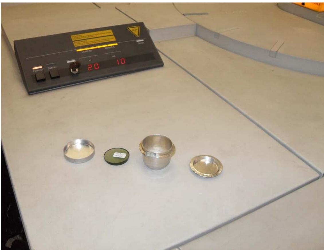
**FIGURA 1.10 – DA ESQUERDA PARA A DIREITA: FORMA DE ALUMÍNIO PARA PRENSAGEM DA AMOSTRA; PASTILHA FUNDIDA E IRRADIADA; CADINHO E PIRES DE PLATINA**
