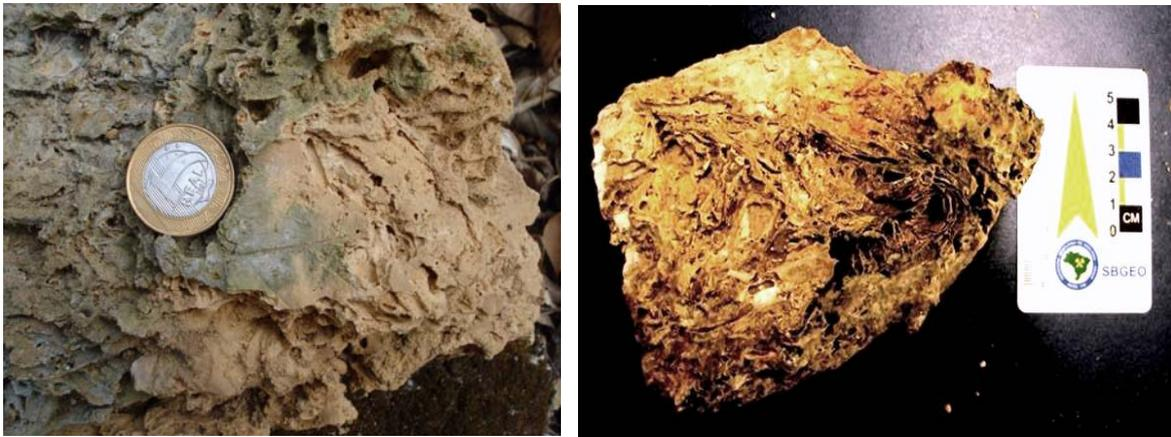
**Figura 41:** (a) Amostra MN168RS retirada do depósito 18 de Março e (b) amostra MN186RS, retirada do depósito Mirindiba. Ambas apresentam elevada porosidade formada por abundantes moldes de vegetais decompostos.
