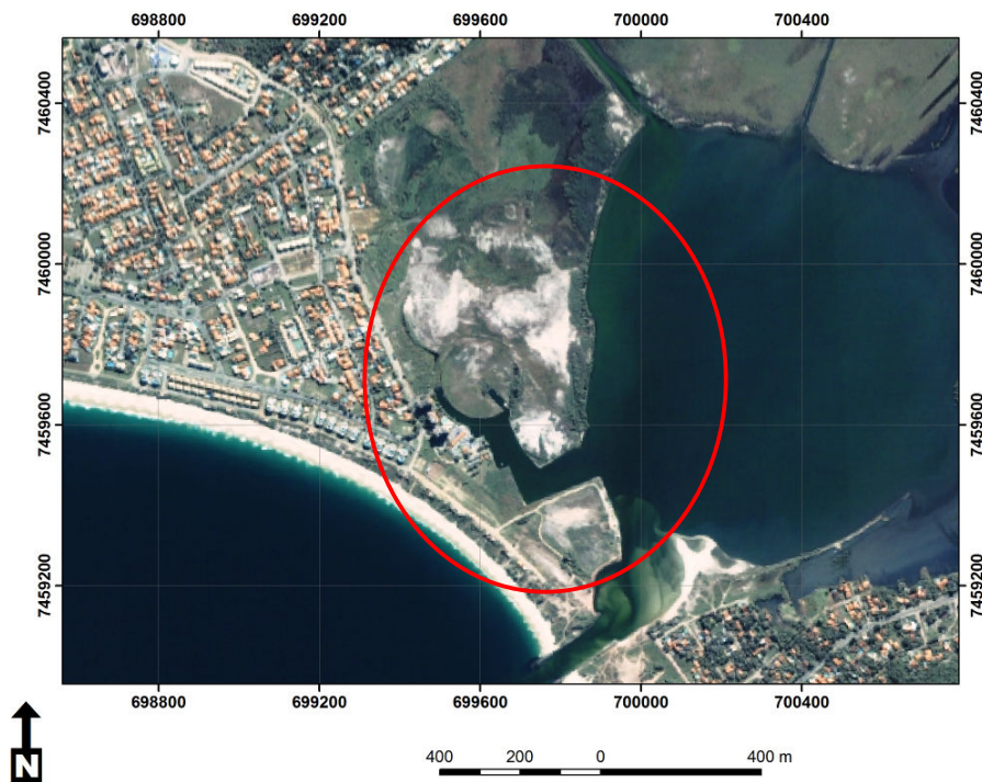
Figura 84 – Imagem de satélite Ikonos, do ano de 2002, destacando a área dos canais da marina hoje desativada, e a porção assoreada a N desta.
