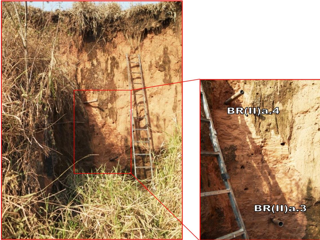
Figura 6.5 – Posição de coleta das amostras BR(II) a.3 e BR(II)a. 4, situadas, respectivamente, a 3,5m e 2,2m abaixo do topo do terreno, em depósitos alúvio-coluviais da “fácies” Quebra-canto da Aloformação Manso.
