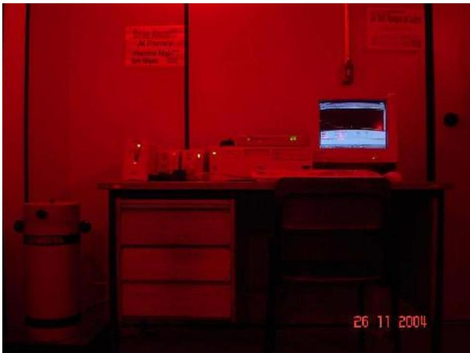
Figura 5.3 - Espectrômetro *Canberra Inspector Portable Spectroscopy Workstation* (imagem cedida pelo LVD-FATEC).
