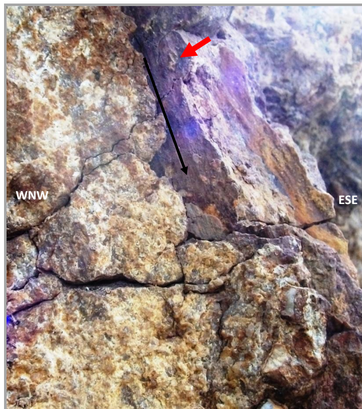
Figura 4.14 – Estrias em plano de falha com orientação 010/80//056/75 e ressaltos, indicando movimento normal com leve componente dextral. Seta preta indicando orientação das estrias. Seta vermelha apontando para um ressalto. Ponto PC-CF-07.
