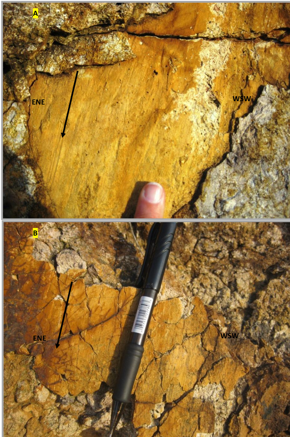
Figura 4.31 – A e B – Estrias bem marcadas em plano de falha polido do cataclasito com orientação 348/63//014/60 indicando movimento normal com leve componente dextral. Setas indicam caimento das estrias. Ponto PC-CF-24.
