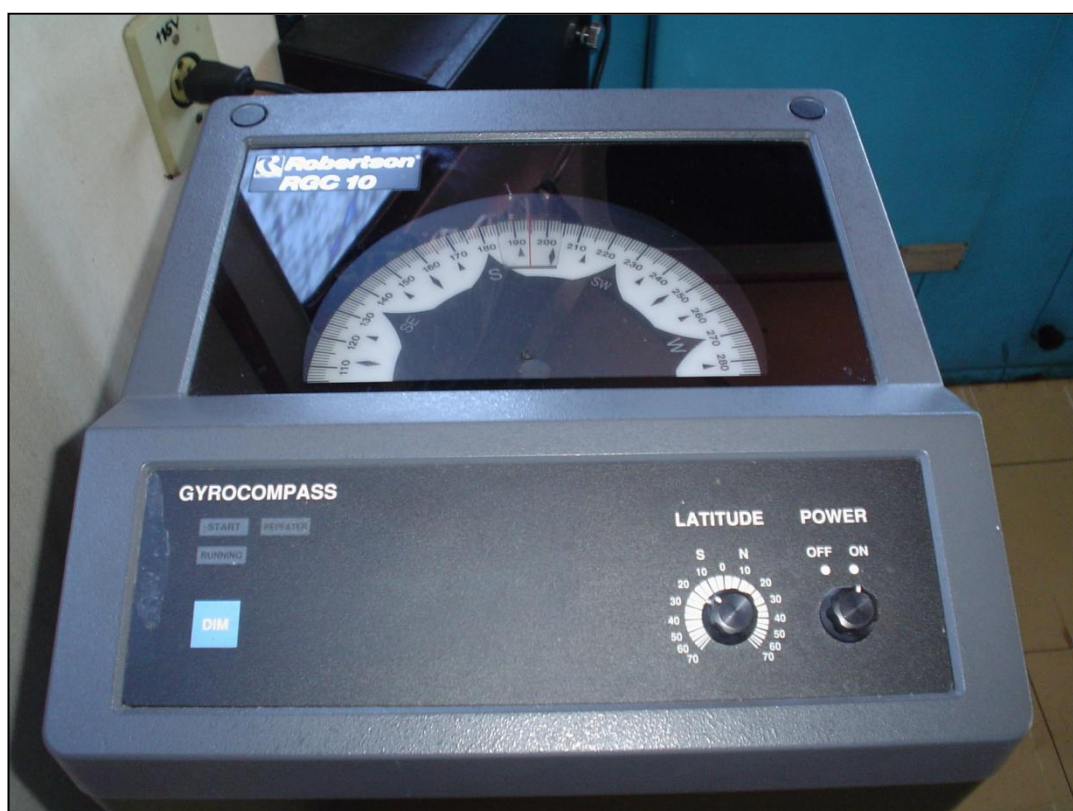
Figura 17: Foto do Giroscópio Robertson modelo RGC 10 usado no apoio a orientação.
