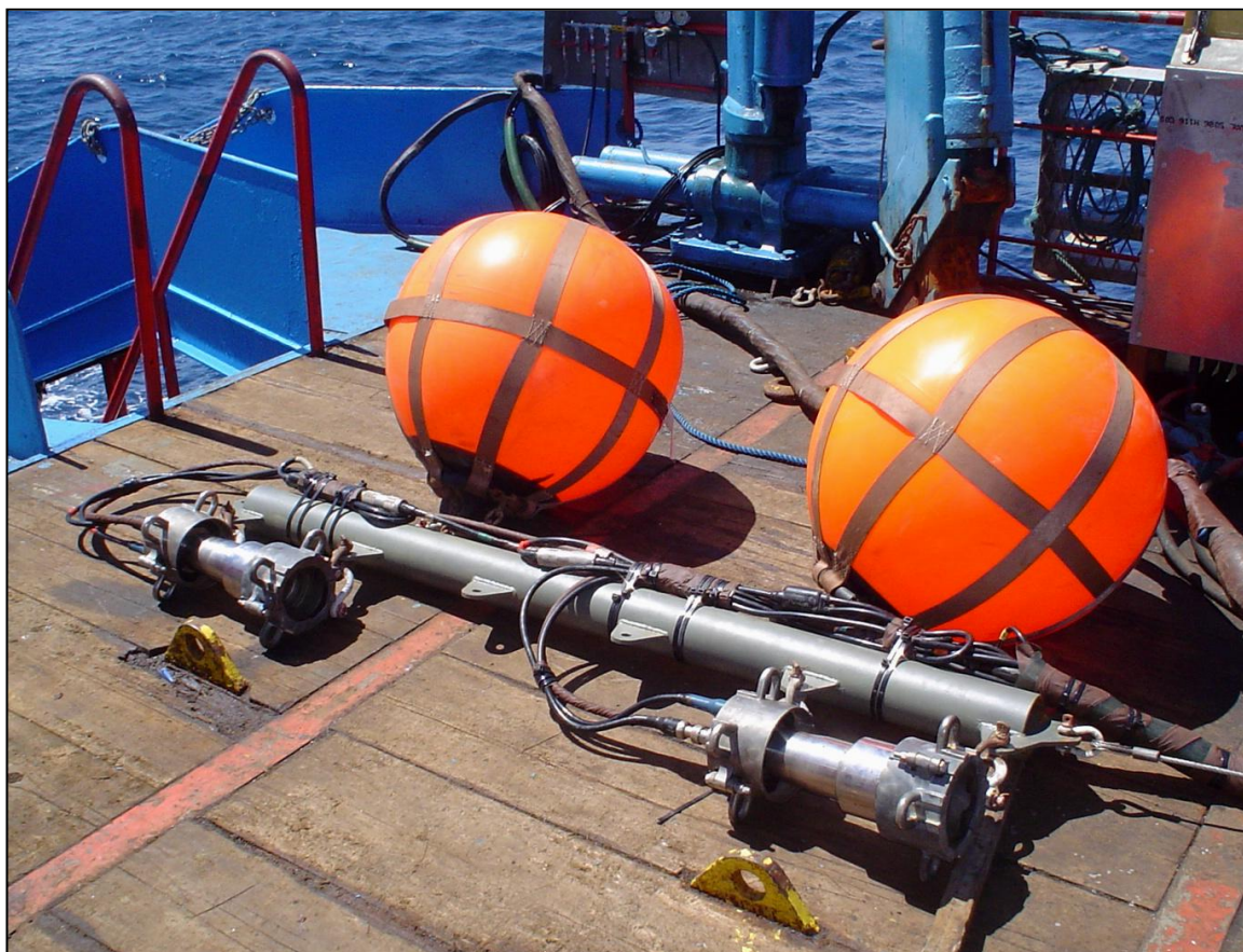
Figura 19: Foto do arranjo dos canhões de ar comprimido.
