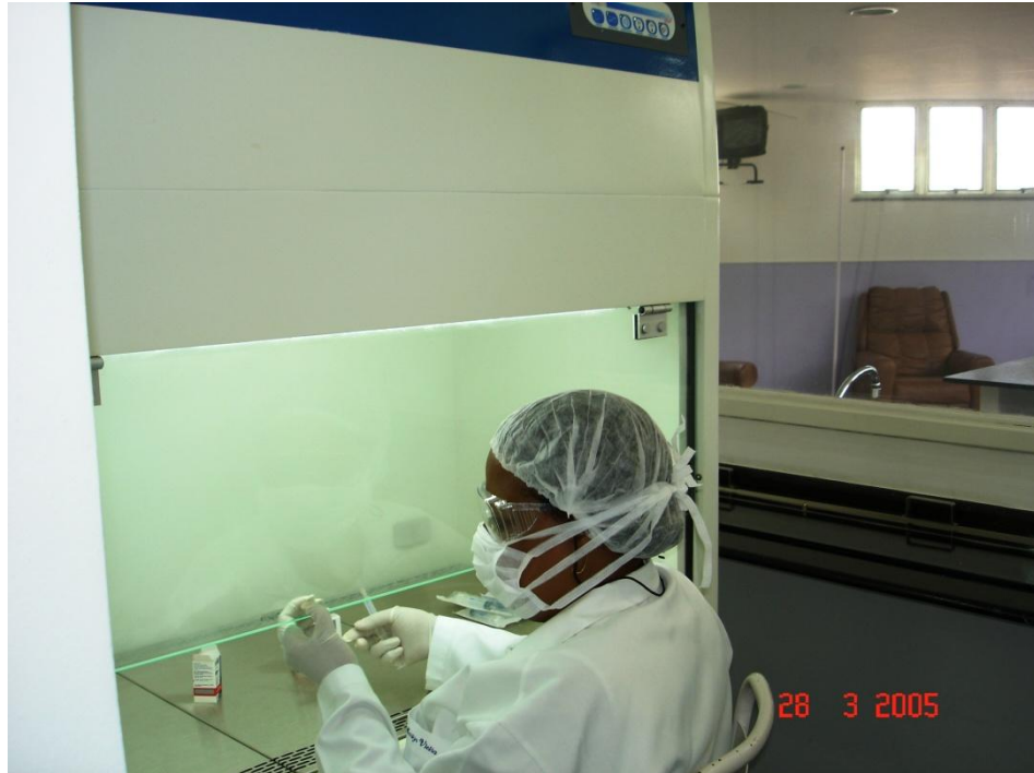
Figura 12 - Câmara de Fluxo Laminar, onde foram processadas inicialmente as amostras de soro. Ambulatório do Serviço de Oncologia da UNIG, localizado no HU São Jose, foto cedida pelo Dr. Marcos Pires e Albuquerque, tirada em março de 2005.
