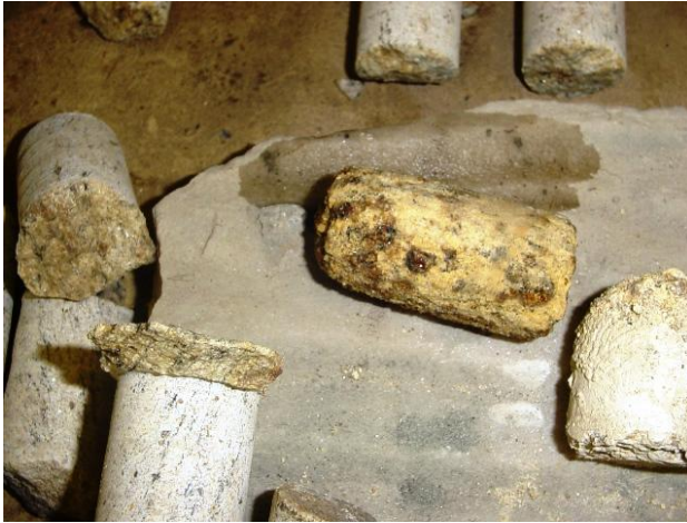
Figura 3.32 Tentativa de produção de corpos de prova do nível 3
