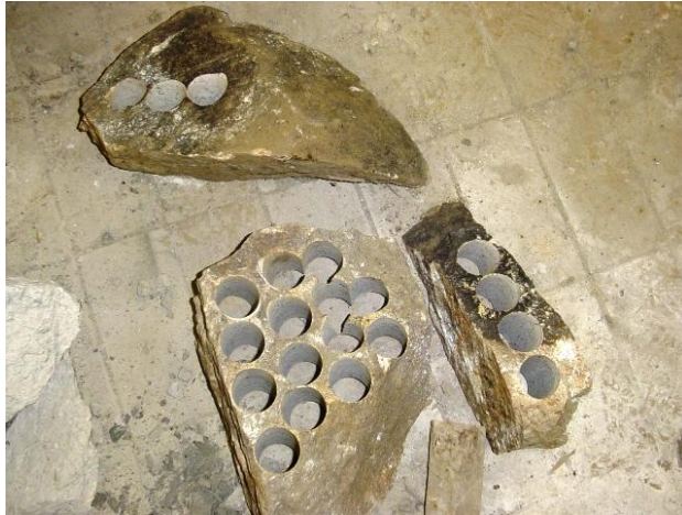
Figura 3.25 Blocos no nível 1 cortados para retirada de corpos de prova
