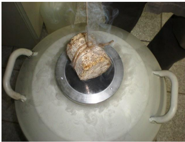
Figura 3.34 Congelamento dos blocos do nível 3 com nitrogênio
