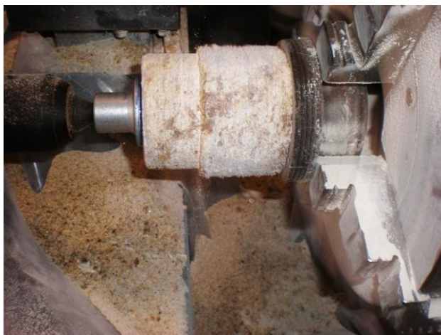
Figura 3.38 Usinagem dos corpos de prova
