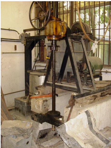
Figura 3.24 Máquina de corte com barrilete amostrador BX
