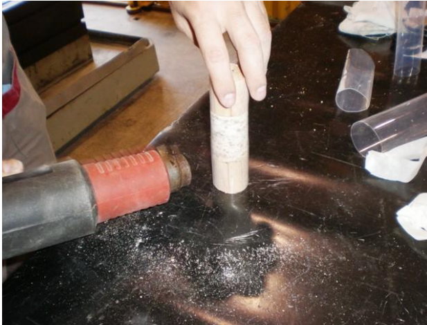
Figura 3.39 Aplicação da membrana termo retrátil para manutenção da consolidação dos blocos
