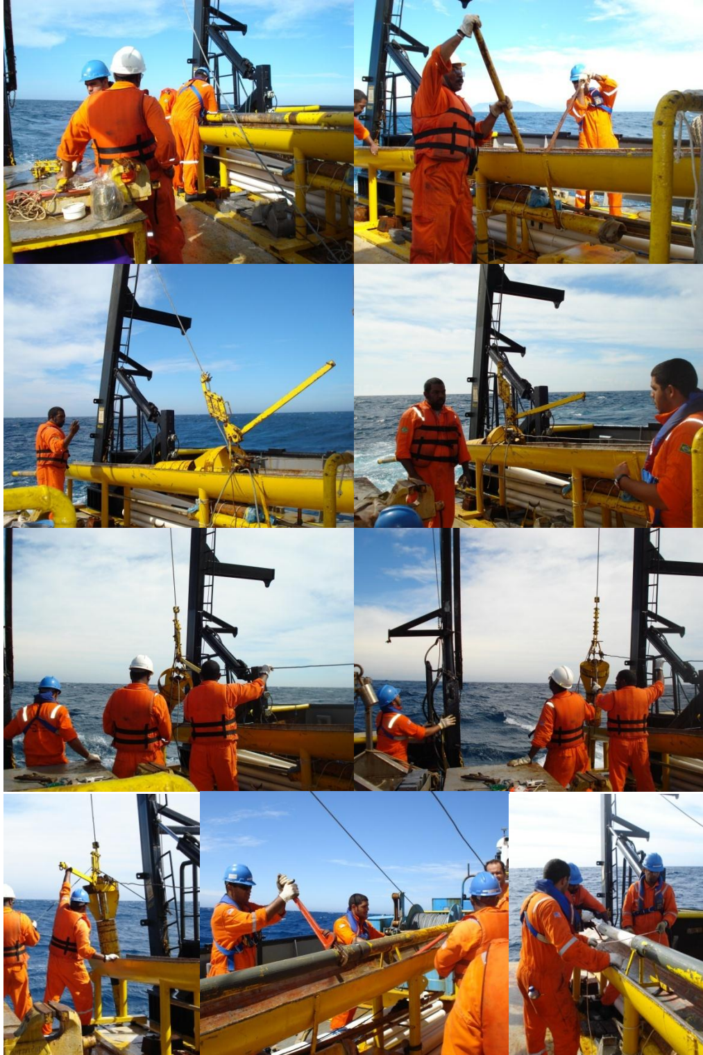
Figura 5: Seqüência de lançamento e retirada dos Kullebergs.
