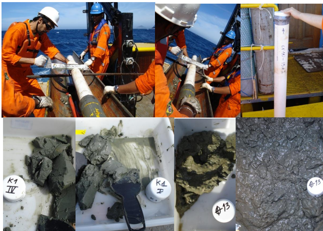
Figura 6: Abertura do Kulleberg e retirada das amostras das bases de cada metro.
