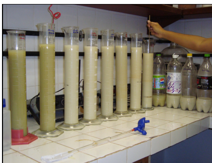
Figura 9: Agitação da suspensão nas provetas para coleta da fração argila.
