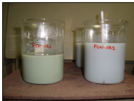
Figura 10: Experimento para retirada dos sais solúveis e matéria orgânica da fração argila das amostras.
