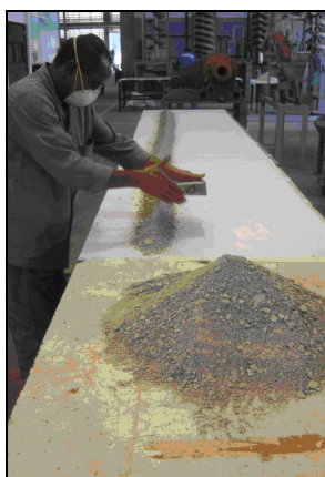
Figura 8: Preparação da pilha cônica para o quarteamento da amostra.
