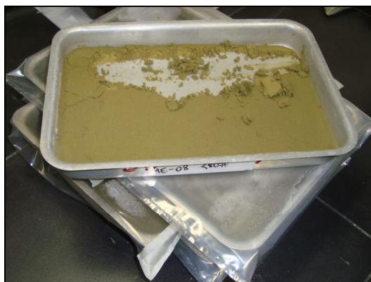
Figura 11: Ativação das amostras com \text{Na}_2\text{CO}_3 .
