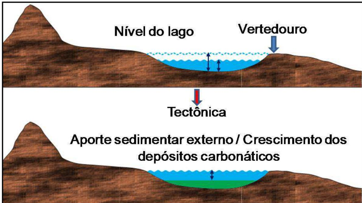
**Figura 6.4** – Principais fatores controladores do espaço de acomodação em um sistema lacustre. Notar que o aporte sedimentar externo tem como efeito: 1) diminuição do espaço disponível para sedimentação; e 2) a redução da fábrica carbonática.
