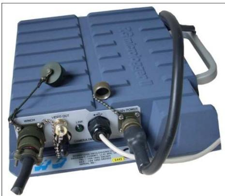
**Figura A-2** - *MicroLogger* e suas conexões
