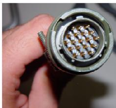
**Figura A-5** – Conector que vai ao *MicroLogger*.
