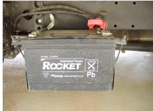
**Figura A-13** – Detalhe da bateria do Caminhão utilizada como alimentação do MicroLogger.
