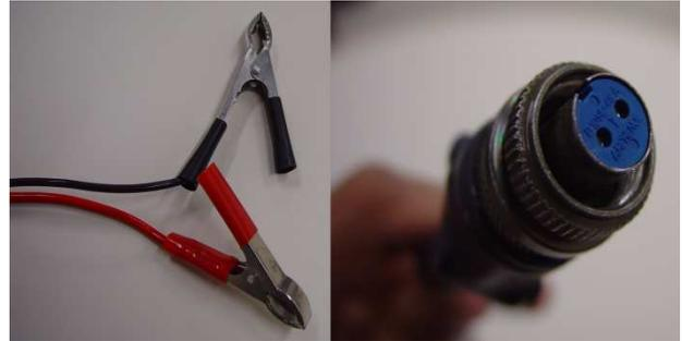
**Figura A-11** – Conectores do cabo de alimentação do MicroLogger.
