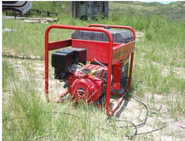
**FiguraA-18** – Foto mostrando o Gerador trifásico
