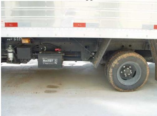
**Figura A-12** – Bateria do Caminhão utilizada como alimentação do MicroLogger.
