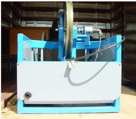
**Figura A-16** – Frente do guincho com o conector do controlador
