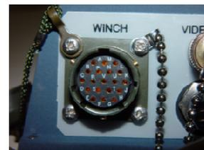
**Figura A-6** – Conector que vai ao cabo que liga ao guincho.
