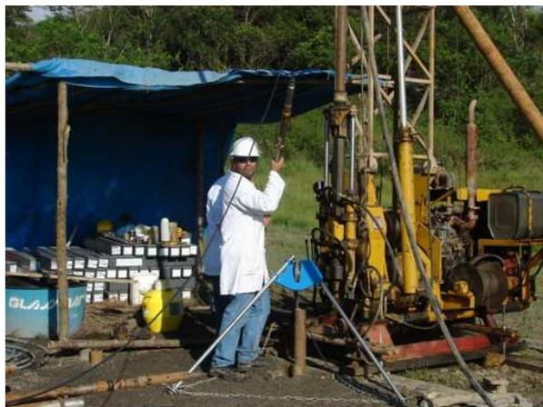
**Figura 23** – Utilização do tripé na boca do poço.
