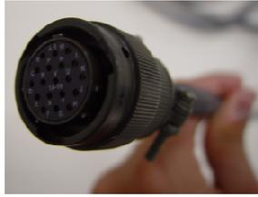
**Figura A-7** – Conector que faz a ligação com o guincho.
