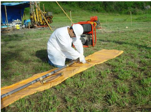
**Figura 21** – Instalação do centralizador no perfilador Sônico.
