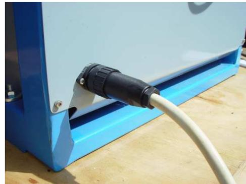
**Figura A-17** – Detalhe da frente rente do guincho com o cabo do controlador conectado.
