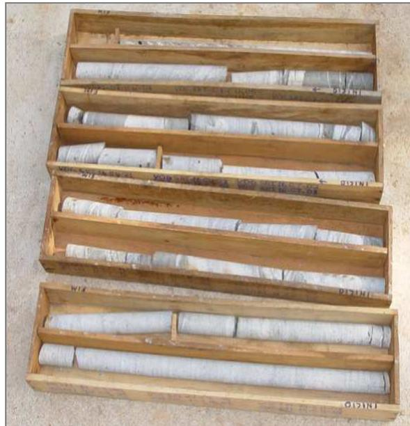
**Figura 3** – Caixas dos testemunhos do poço UFRJ-1-RJ. Foto Gauza (2011).
