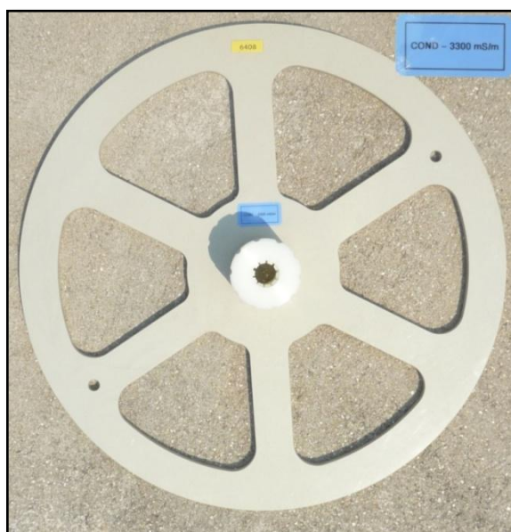
Figura 28 – Anel de Calibração com detalhe do seu valor de condutividade – 3300 mS/m.
