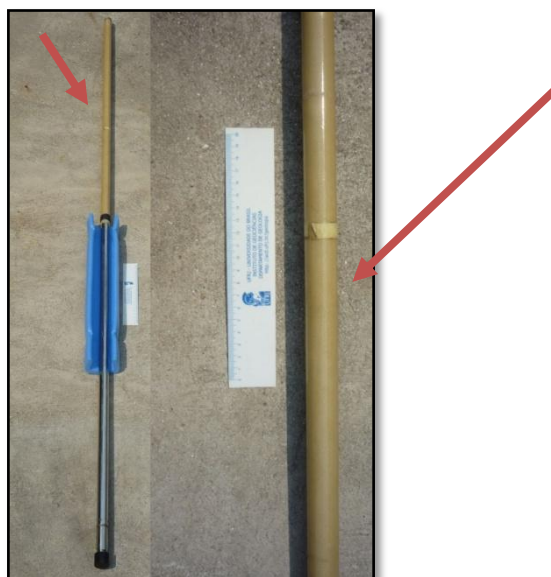
Figura 27 – Ferramenta Slim Induction Tool ® com detalhe para a parte não condutora (indicada pela seta em vermelho), onde se localizam as bobinas. Foto: Geneci Coelho, 2010.
