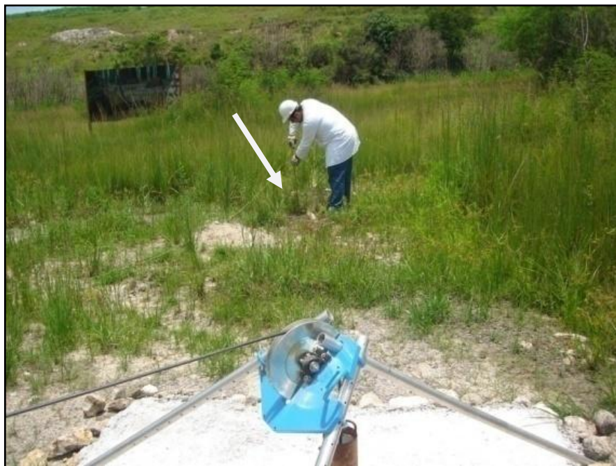
Figura 33 – Aterramento sendo feito durante processo de perfilagem. A haste do aterramento está indicada pela seta em branco. Foto: Paula Rocha, 2010.
