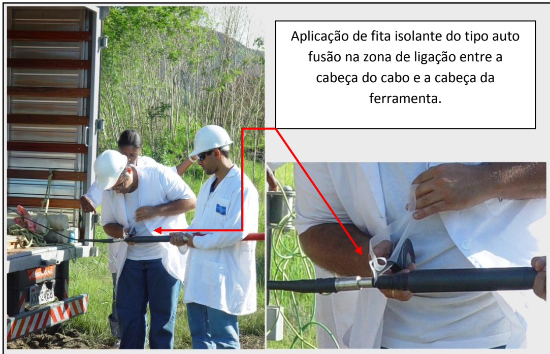
Figura 25 – Preparação da ferramenta E-Log com fita auto fusão, com detalhe da aplicação da fita na zona de conexão entre o cabo e a cabeça da ferramenta. Se este procedimento não for realizado, ocorrerá dano permanente a ferramenta. Foto Paula Rocha, 2009.
