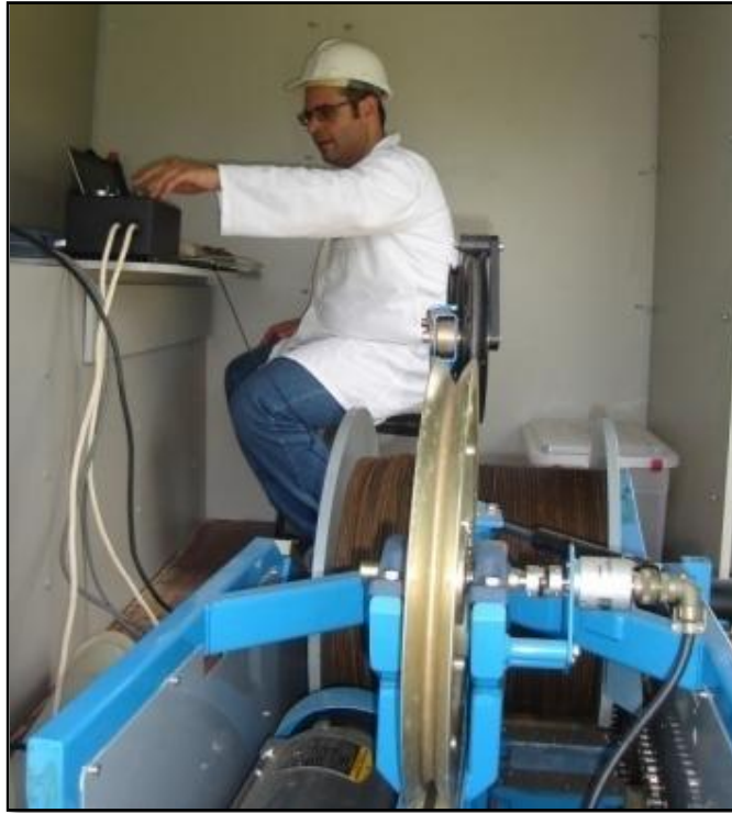
Figura 31 – Bancada / armário sendo utilizada em operação de perfilagem. Foto Paula Rocha, 2010.
