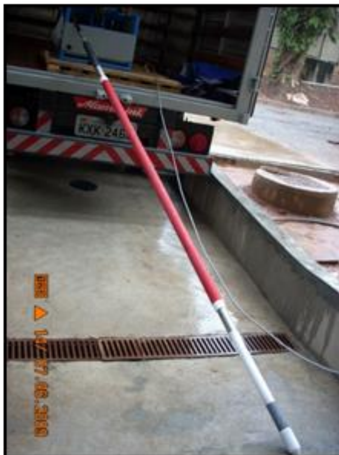
Figura 2 - Ferramenta de Perfilagem (Electric Log – Foto de Ana Gauza, 2009).
