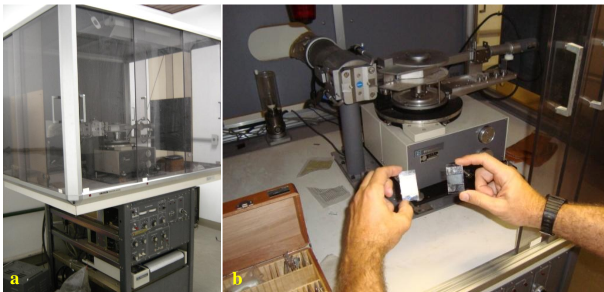
Figura 4.25 – Difratômetro da marca Rigaku, modelo Geigerflex-2013; a) vista geral do difratômetro; b) compartimento de armazenamento da lâmina.
