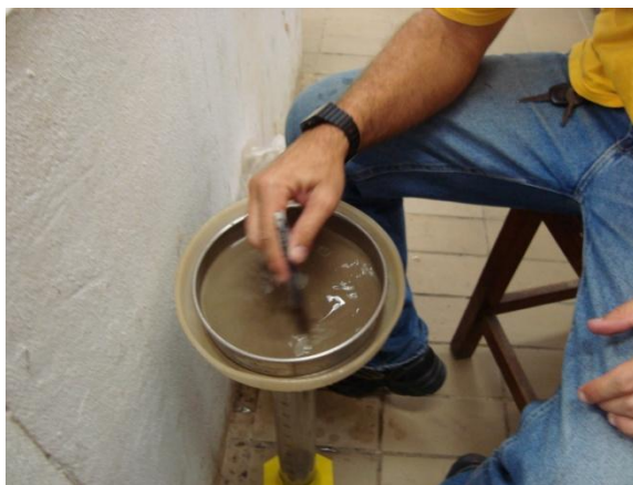
Figura 4.16 – Passagem do material na peneira 270 para obtenção dos finos.
