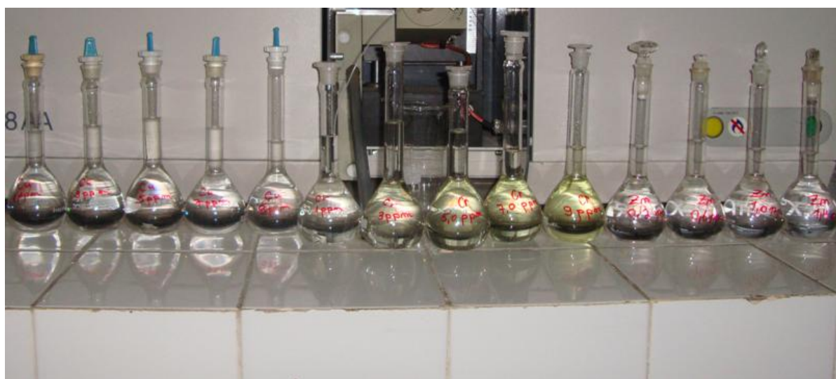
Figura 4.31 – Balões volumétricos com diversas concentrações de solução padrão de Cu, Cr e Zn.
