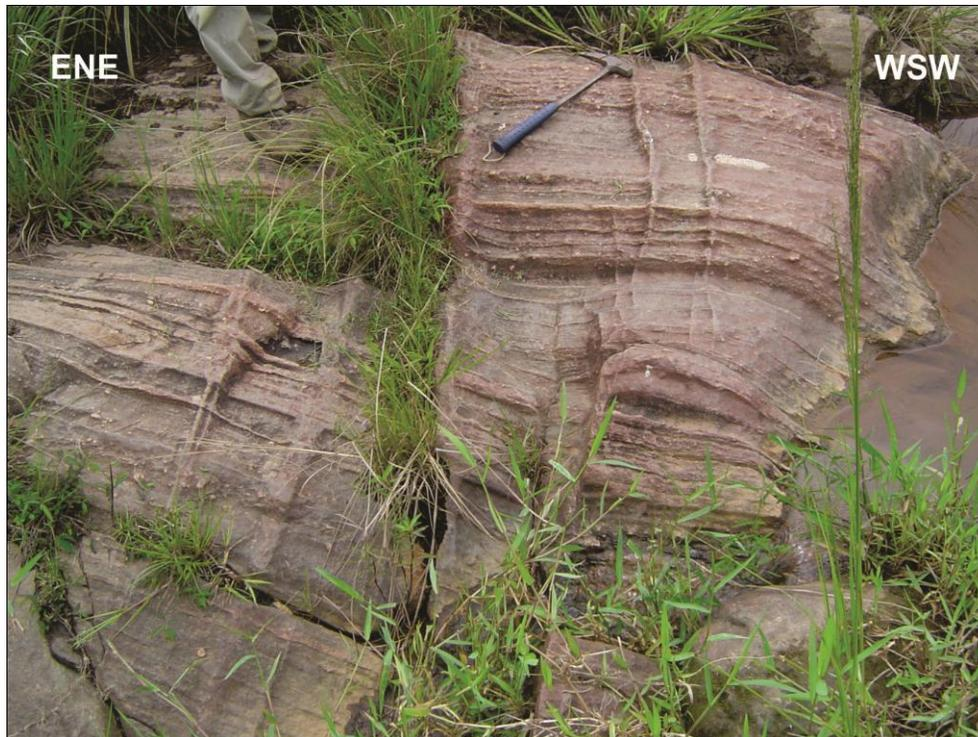
Figura 90: Planos de fratura rúptil em biotita-piroxênio-hornblenda ortogneisse (OSP-165).
