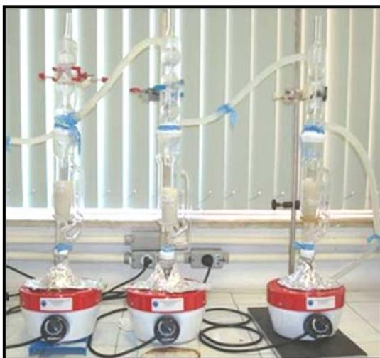
**Figura 20.** Extrator do tipo Soxhlet utilizado para extração da matéria orgânica (LAFO/UFRJ)
