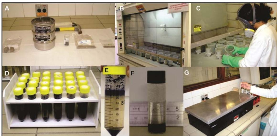
**Figura 33.** Esquema de preparação das amostras para análise de palinofácies: **A** - Fragmentação da amostra; **B** e **C** - Acidificação e neutralização; **D** - Separação por flotação utilizando-se  $ZnCl_2$ ; **E** - Resíduo Orgânico – sobrenadante; **F** - Concentrado de matéria orgânica; **G** - Montagem da lâmina (Mendonça Filho *et al.*, 2010a).
