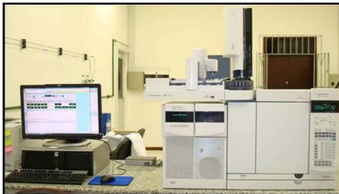
**Figura 25.** Cromatógrafo à gás Agilent Technologies (Palo Alto, CA, EUA) modelo 7890A acoplado a um espectrômetro de massas quadrupolar Agilent Technologies (7000B) (LAFO/UFRJ).
