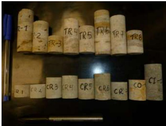
Figura 11- Fotos dos plugs utilizados nos ensaios de porosidade e permeabilidade: calcário travertino (TR) na fileira superior e brecha carbonática (CR), calcário oolítico (CO) e conglomerado matriz suportada (CI) na fileira inferior.
