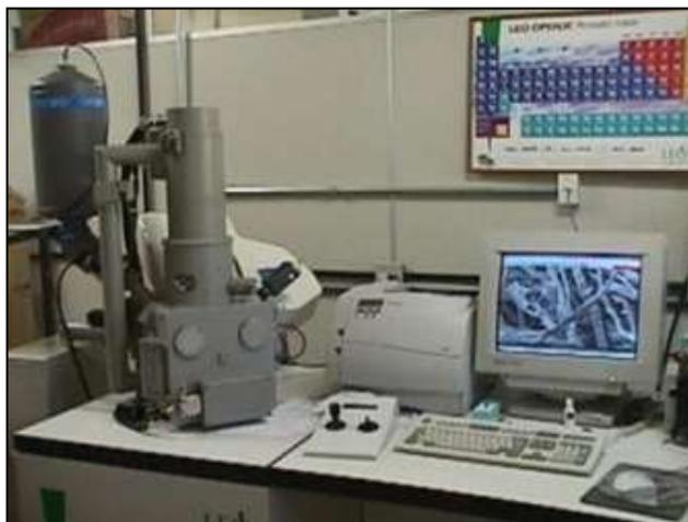
Figura A1: Foto do equipamento de Microscopia eletrônica de varredura (MEV) utilizado na USP. (<http://caqi.iqsc.usp.br/files/2009/02/15a.jpg> - acessado em maio de 2011).
