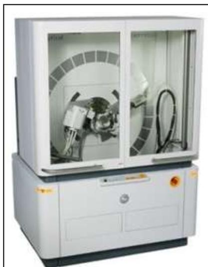
Figura 14: Equipamento de difração de raios X utilizado neste trabalho e que pertence ao laboratório da USP
