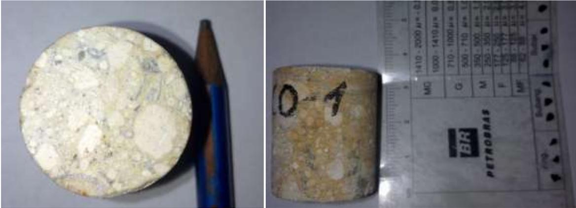
Figura 44 - Fotos do *plug* de calcário oolítico (CO) utilizado nos ensaios de petrofísica .
