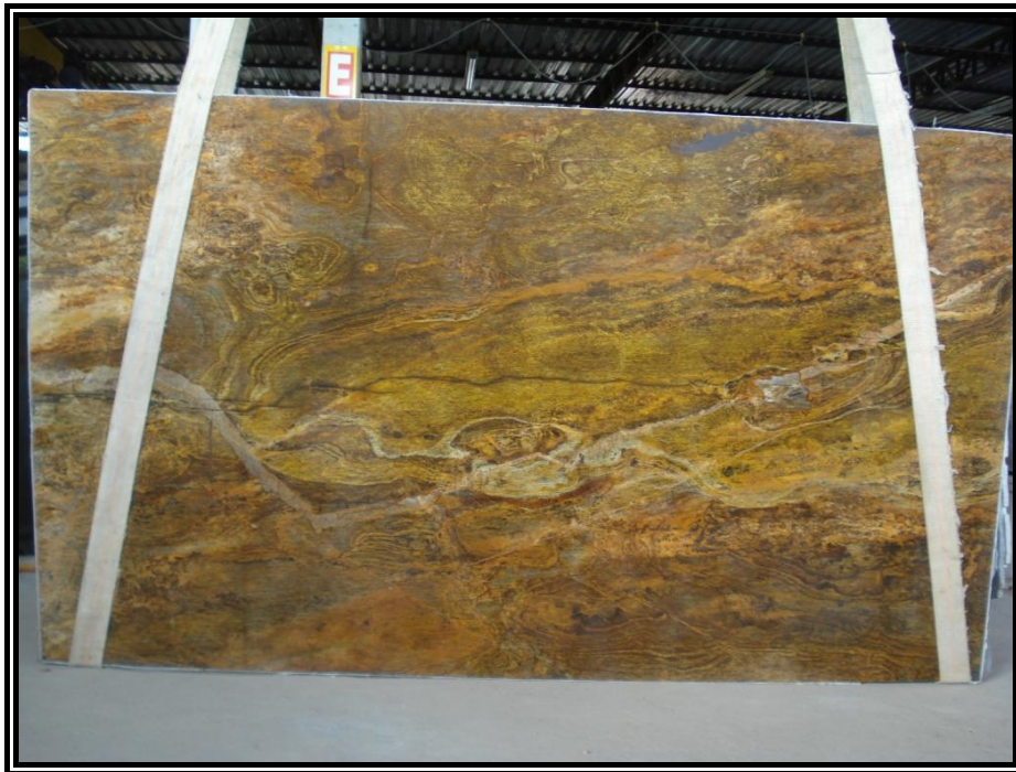
Figura 17: Foto de detalhe da movimentação visual com fissuras e da cor amarelada na placa.
