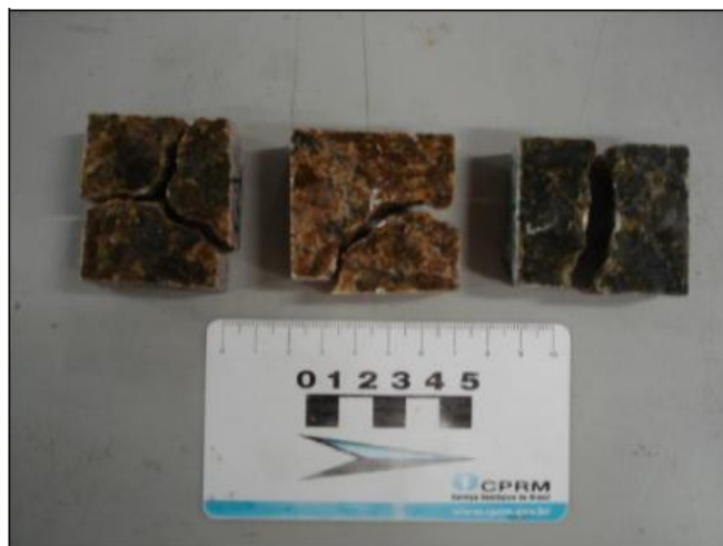
Figura 21: Exemplo de fraturas consideradas válidas no ensaio de point load (Teixeira, 2009).
