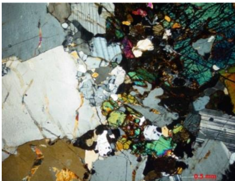
Figura 33: Lâmina do charnockito submetido à ciclagem em sal após 40 ciclos (nicóis cruzados).
