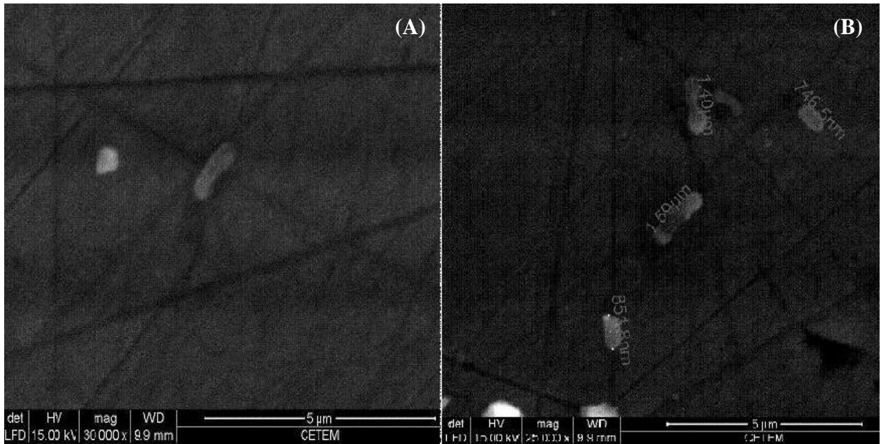
Figura 28. Imagem da adesão do micro-organismo na superfície da calcopirita (A) e dimensões médias da bactéria na face da amostra (B) após um dia de ensaio, obtidas através do MEV.
