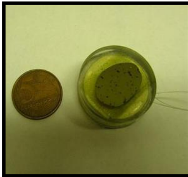
Figura 14. Seção polida de calcopirita utilizada na visualização dos micro-organismos mesofílicos
