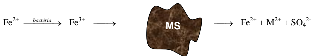
Figura 8. Mecanismo indireto de interação bactéria-substrato mineral.
