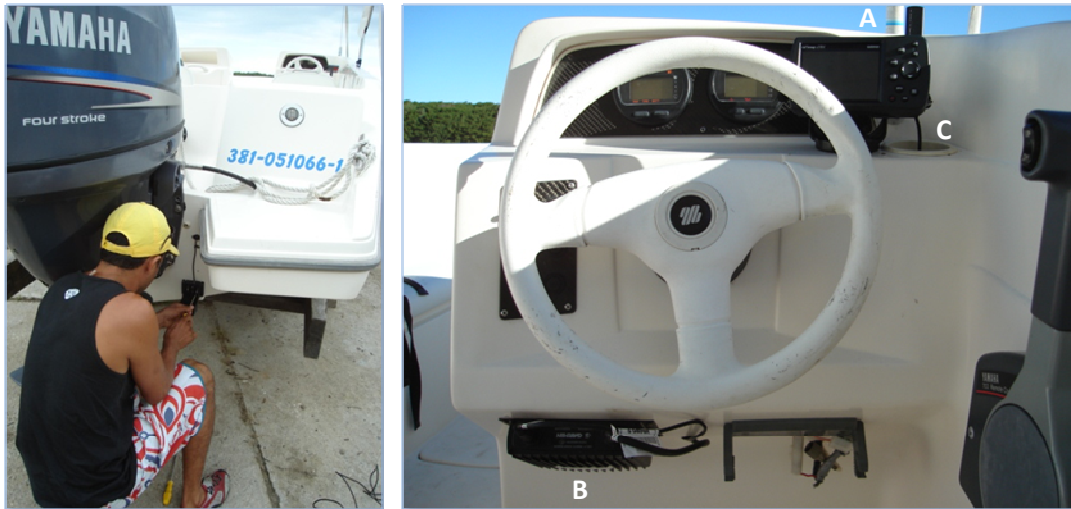
Figura 7: Sistema integrado de aquisição de dados batimétricos georeferenciados; A) GPS Garmim GPSMAP 276 C; B) Ecossonda Garmim GSD 21; C) Cabo de dados - transducer .
